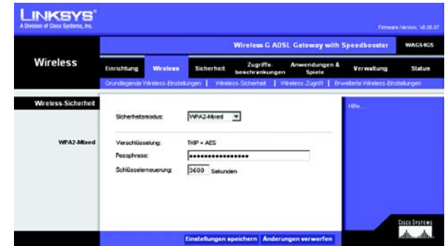
Abbildung 6-18: Wireless Security Sicherheit im Wireless-Netzwerkbetrieb – WPA2 Gemischt
